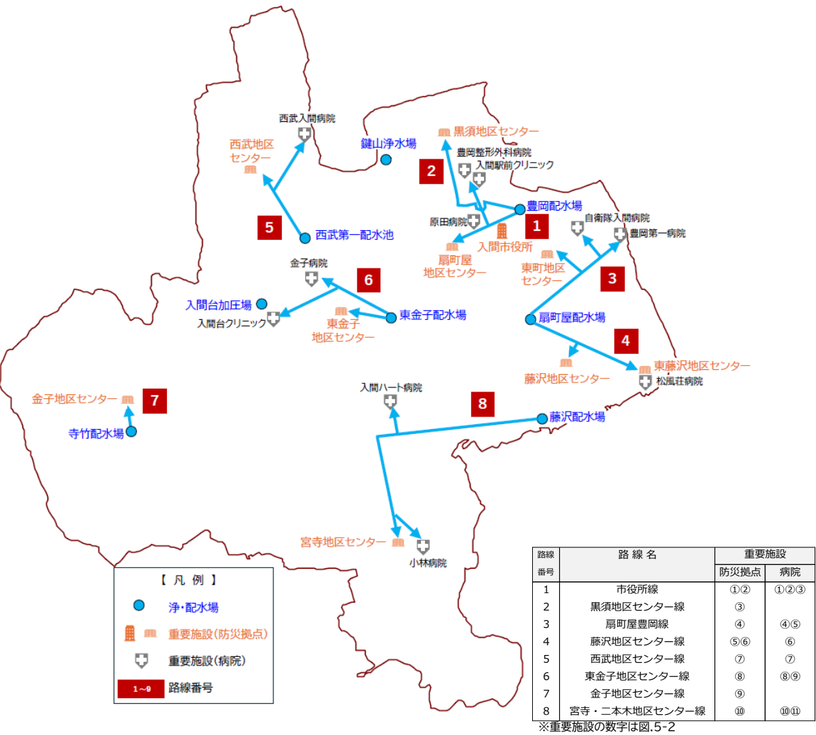
図 5-2 重要施設に接続する水道管路
